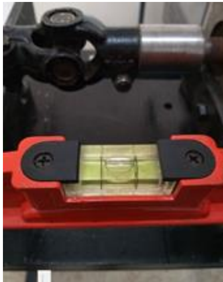
Figura 6 – alinhamento do sistema no sentido axial do eixo.
